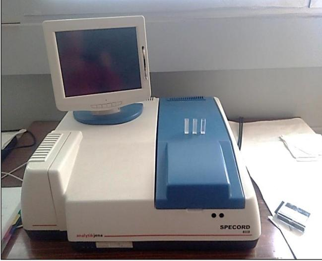
شكل (3): جهاز مطياف فوق البنفسجي - الضوئي (UV-Visible Spectrophotometer)
