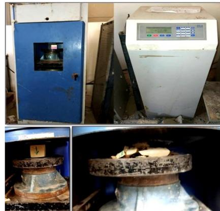
شكل (9): جهاز اختبارات الضغط وعينات الحجر الجيري أثناء إجراء اختبار الضغط
